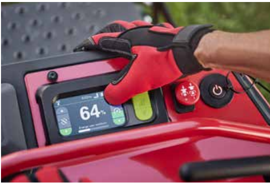
Il pannello digitale, di facile utilizzo da parte dell'utente, mostra lo stato del rasaerba e la velocità di guida.
